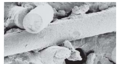
REM Aufnahme der Bruchfläche einer Probe aus PA 6T/6I-GF40MX2
