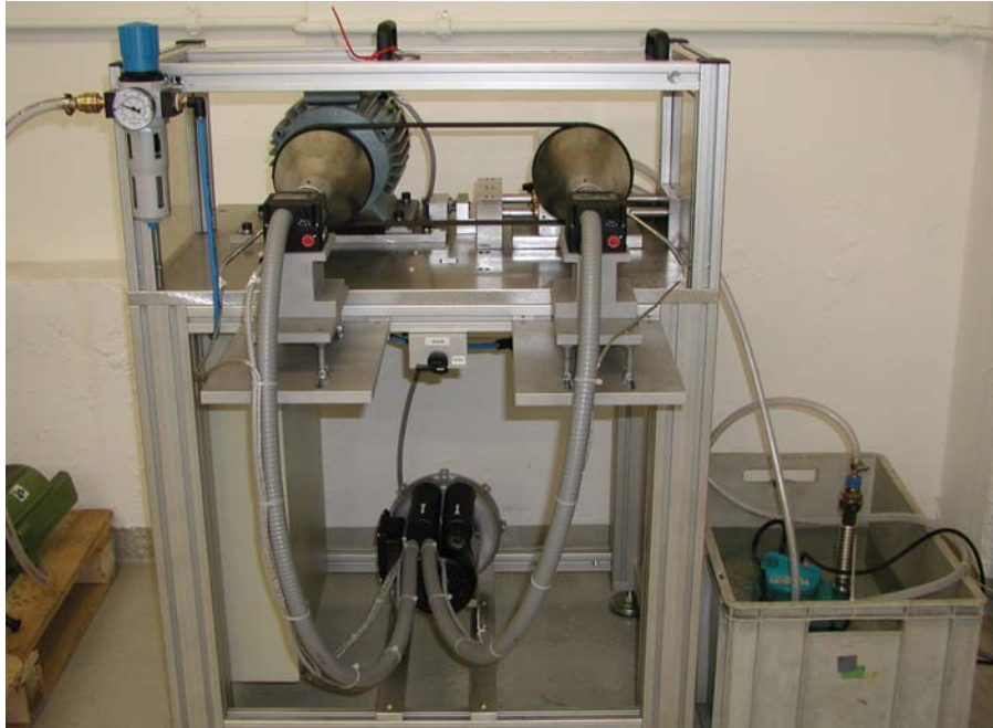
Abb. 10: Prüfstand für Riemenscheibe [20]
