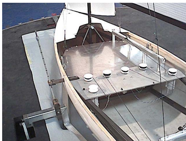
Abbildung 10: Im Inneren des Modells befinden sich ferngesteuerte Winschen, um die Modellsegel wie in der Realität zu trimmen.
