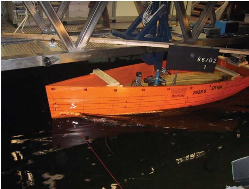
Abbildung 8: Schleppversuch mit dem Modell einer 10m Yacht
