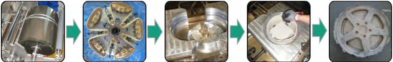
Abb. 4: Produktion einer hybriden SMC-Felge; Wickeln der Rovings, Platzierung im Werkzeug zusammen mit Inserts, einbringen des SMC Halbzeugs, gepresste Felge [7]
