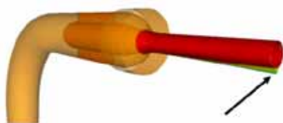
Abb. 3: Simulation der Freistrahlsströmung nach einem 90° Krümmer
