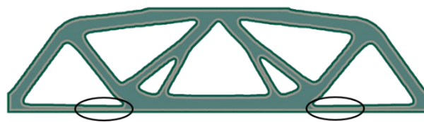
Abb. 7: Resultierendes Design für Optimierungsfall 2 inkl. Darstellung der SLM-spezifischen Materialbereiche für die Topologieoptimierung unter Berücksichtigung der porenbehafteten Bereiche
