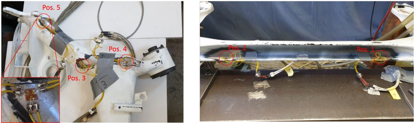
Abb. 6 Messpunkte der Dehnungsmessung
