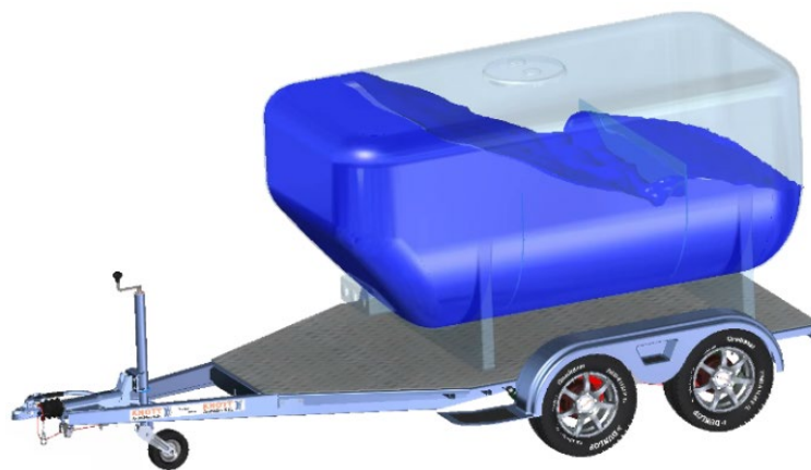
Abb. 7: Tankanhänger mit Prallblechen ausgestattet
