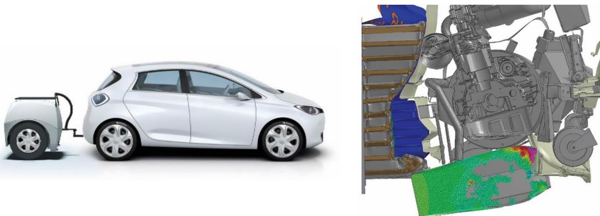
Abb. 1: Simulation eines Heckaufpralls mit Schwappverhalten der Flüssigkeiten im Tank durchgeführt mit dem Wasserströmungsmodul in ESI-VPS. (Mit freundlicher Genehmigung von EP Tender)
