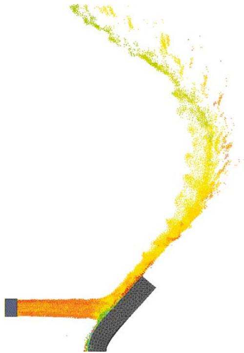
Abb. 5: Interaktion zwischen einem Wasserstrahl und einer flexiblen Struktur. Simuliert mit dem Wasserströmungsmodul in ESI-VPS.
