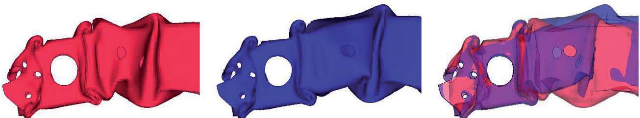
Abb. 3: Deformations-Formen des Streuungs-Moden für den Längsträger
