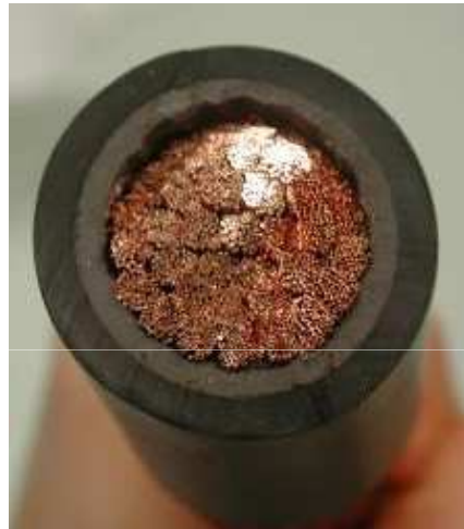
Câble d'énergie monoconducteur – Basse Tension Section : 400 mm 2 Nombre de brins de cuivre : ~2700
